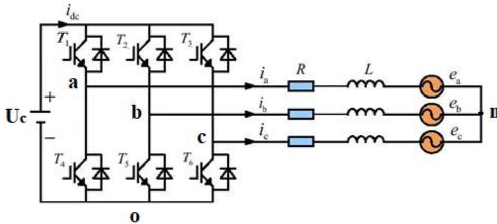
Figure 9 – Structure de l'onduleur triphasé
