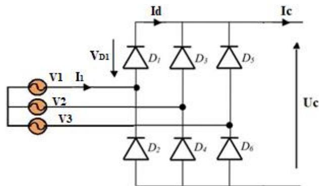
Figure 8– Structure de redresseur triphasé
