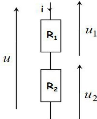
**Figure 1 :** Pont diviseur de tension
