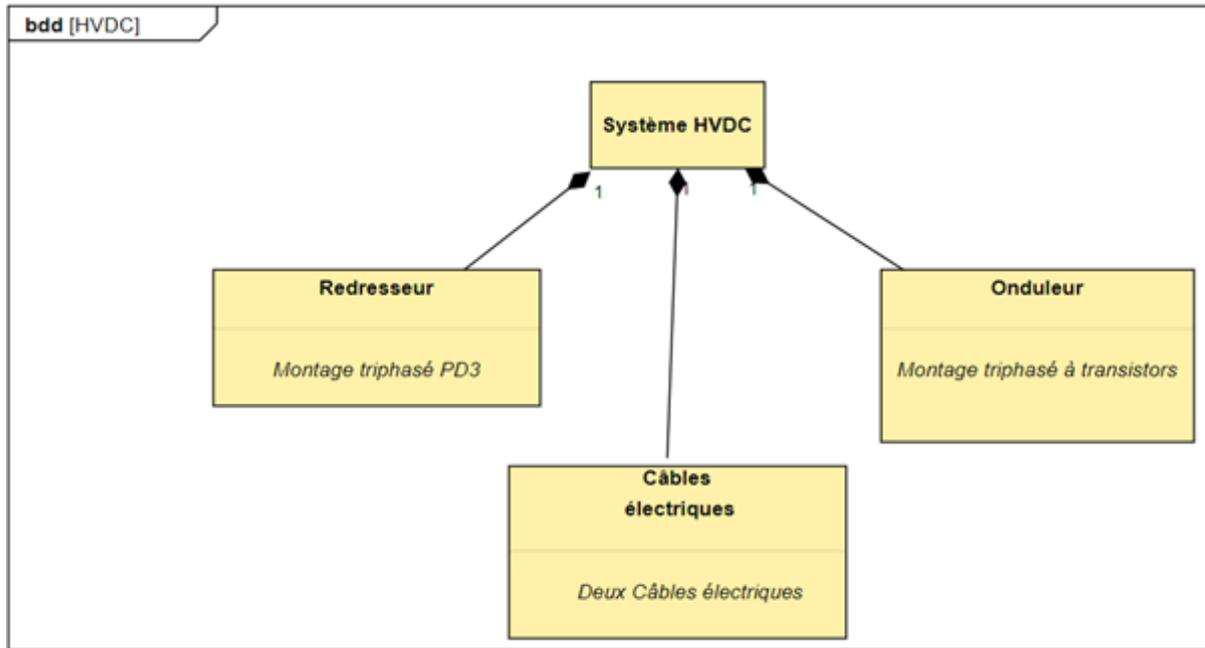
Figure 4- Diagramme de définition des blocs
