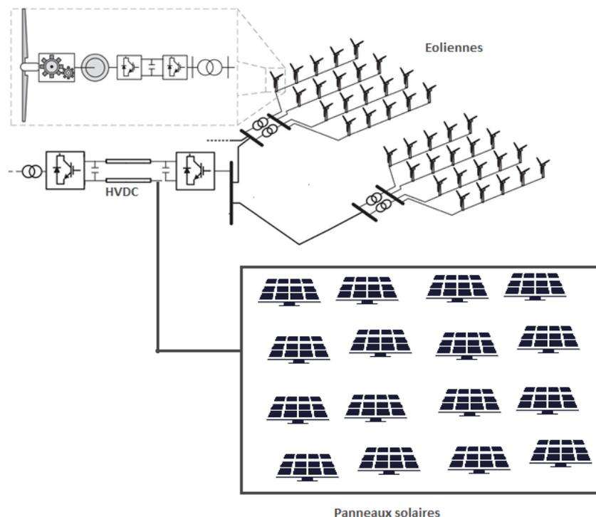
**Figure 3** - Éléments constitutifs la chaîne de transmission
