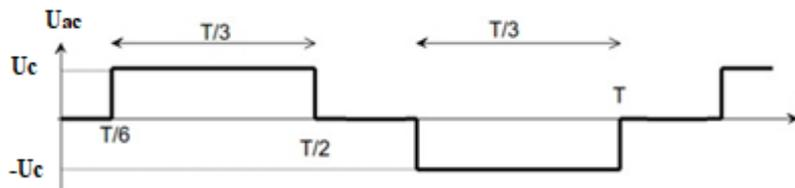
Figure 11– Tension composée produite par l'onduleur
