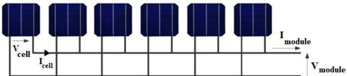
**Figure 5b** : cellules connectées en parallèle
