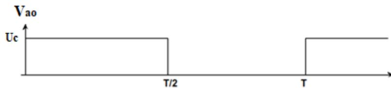
Figure 10- Tension simple produite par l'onduleur
