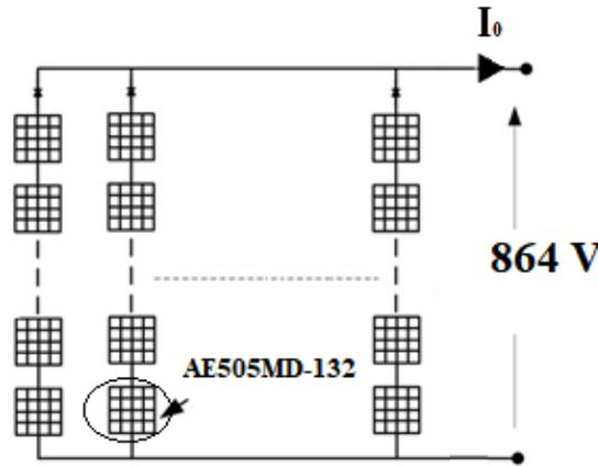
**Figure 7** – Structure d'un générateur à N modules
