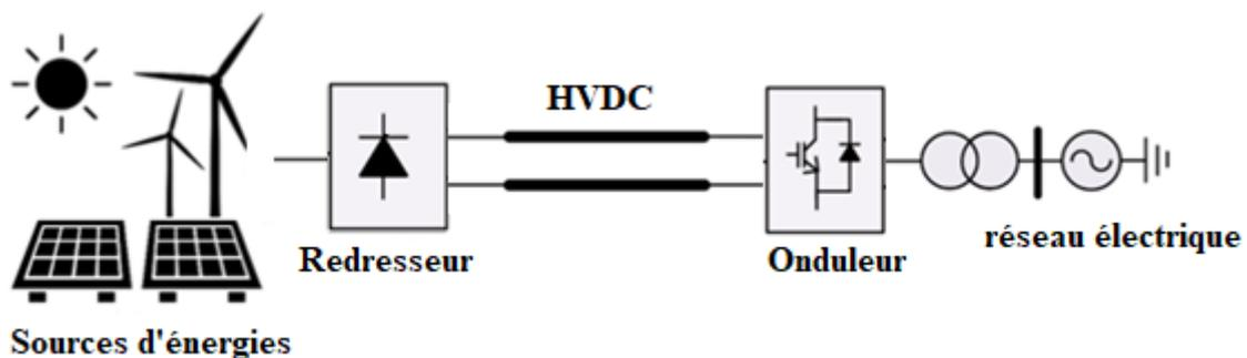
**Figure 2 - Liaison entre deux stations de conversion d'énergie**
